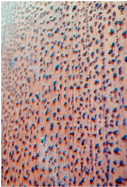
Abb. 4b: Darstellung des Alterungsprozesses. Das Leinöl ist an der Bauteiloberfläche praktisch vollständig abgebaut. Im Streiflicht sind die Harzrückstände als Molekülinseln erkennbar.
