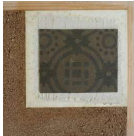
Abbildung 5: Mustertafel mit aufgezogenem Linoleumbelag.
